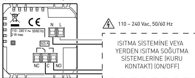
Isıtma sistemlerinde şebeke gerilimi ile kontrol edilen yükler için (örn. 230 V AC selenoid vana)
