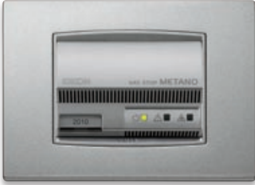
Metan gazı detektörü. Sürekli olarak gaz kaçağı olup olmadığını kontrol eder ve tehlike durumunda uyarı vererek eve giden gaz beslemesini keser.
